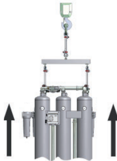
II: Mise en place avec grue
